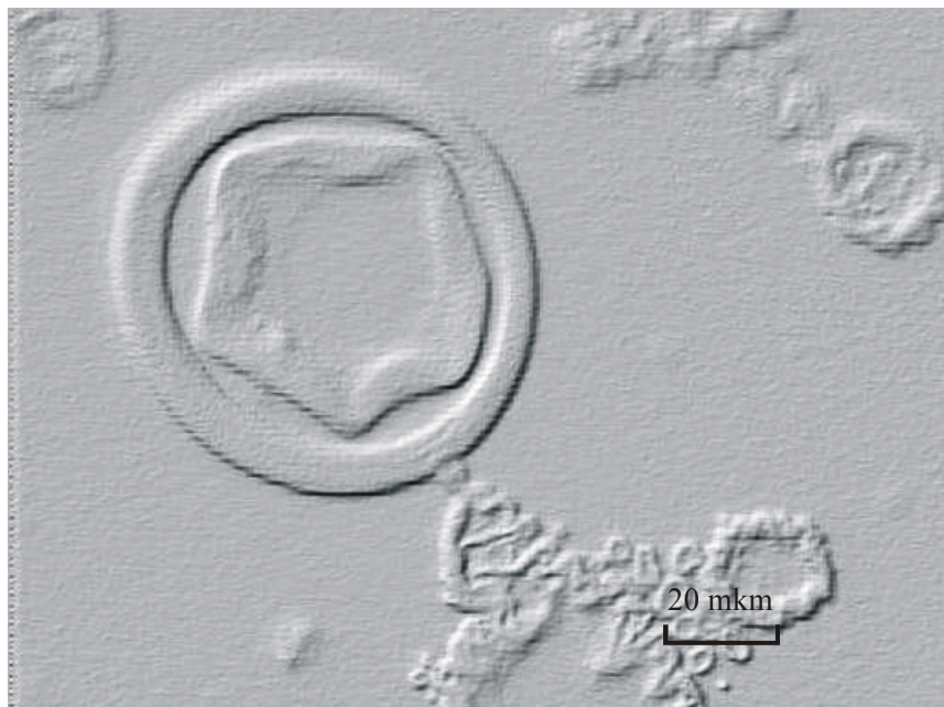
Рис. 1 Топология медной пленки, сформированная под воздействием фрактально-матричного структуризатора.
