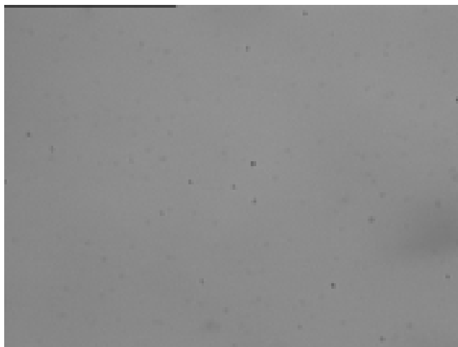
Рис.1. Микрофотография медной пленки, полученной магнетронным распылением в стандартных условиях
